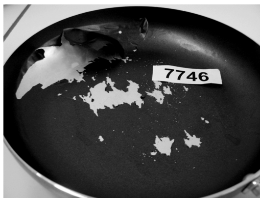
Abb. B-9: Pfanne mit abgelöster Antihafbeschichtung
